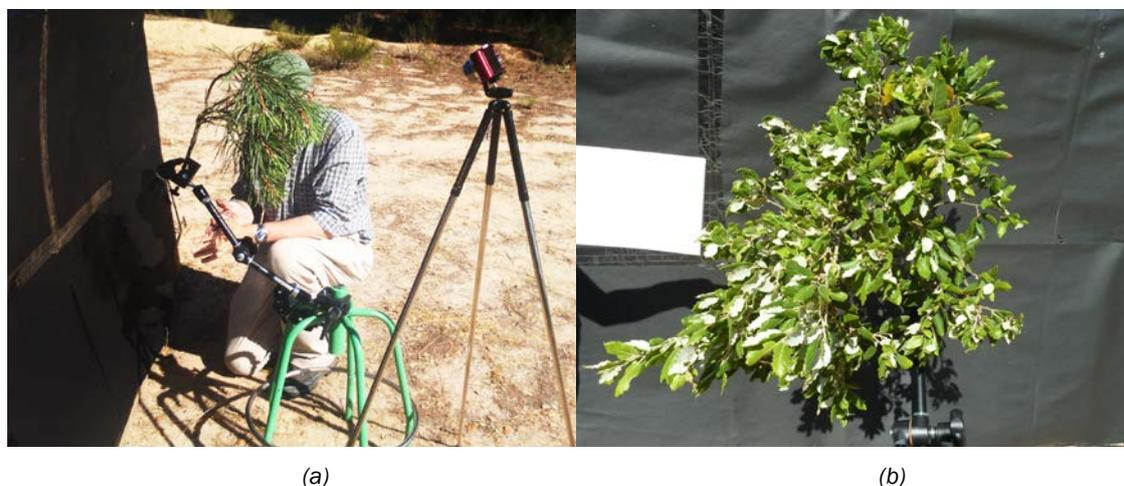
Figura 1. Ubicación de ramas en brazo móvil (a) y toma de fotografías con fondo negro (b) orientando la rama en tres posiciones que simulaban distintos ángulos de incidencia de los rayos solares.
