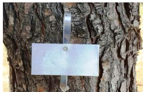
Resorte en posición vertical (Muy útil para aprovechar las fisuras longitudinales de la corteza donde encajar la anchura del resorte y fijarlo de esta manera, evitando que gire por acción de los elementos)
