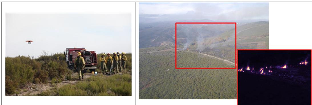
325 Figura 5. El sistema AibotX6 integrado en la operativa de quemas (izquierda); Imagen RGB y térmica de la parcela 326 durante la quema (dcha).
