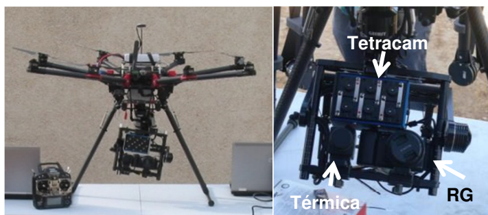
190 Figura 1. Plataforma multisensor experimental: multirrotor DJI S1000 y sensores multiespectral (Tetracam \mu MCA6), 191 térmico (FLIR A65) y cámara compacta (Sony Alpha 5100).
