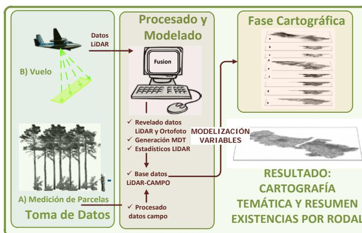
Figura 4. Esquema de trabajo LIDAR para el proceso de datos en inventario forestal
