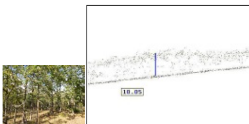
Figura 9. Perfil LiDAR (derecha) de un “Tallar Latizal no muy denso” como el reflejado a la izquierda.
