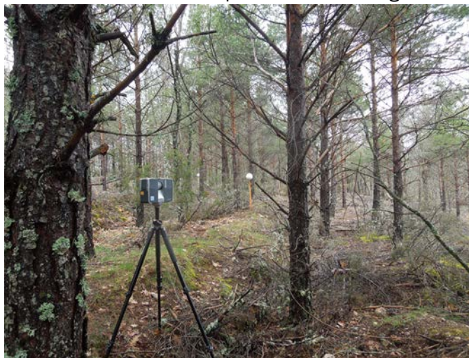
Figura 2. Un posicionamiento del TLS, procurando que capture el máximo posible de puntos de referencia (esferas blancas con los que se construirán posteriormente las imágenes 3D de la parcela).
