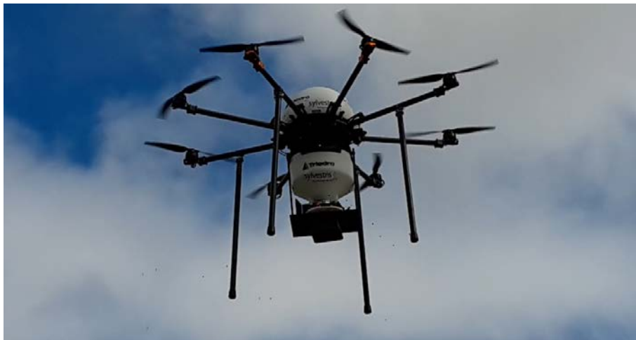
Figura 7. Octocóptero con dispositivo sembrador desarrollado por las empresas TRIEDRO y SYLVESTRIS
