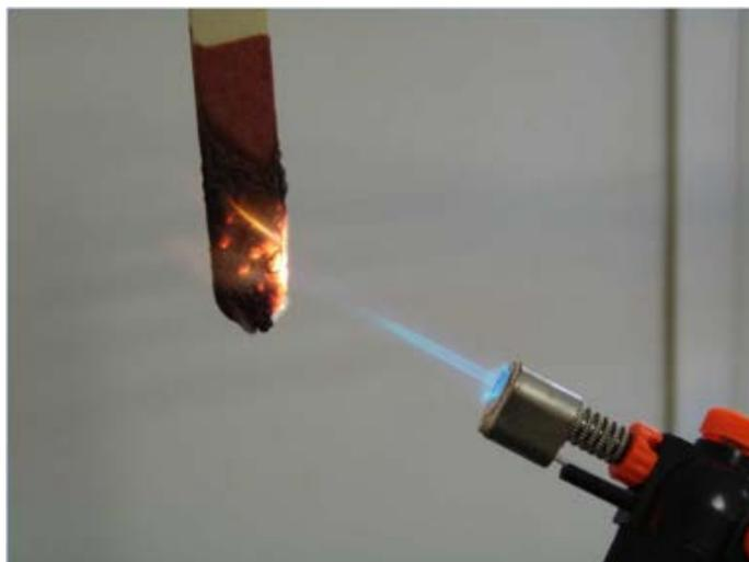
Figura 1. Descomposición del polifosfato en presencia de una fuente de calor. Fotografía: Budenheim
