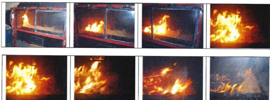
Figura 4. Bandeja de quemado test de eficacia CEREN. Fotografía: CEREN
