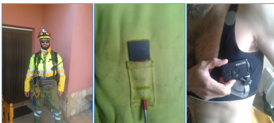
Figura 1. PEEIF equipado con buzo sensorizado previo a salida a incendio. Detalle de sensor de flujo de calor. Sistema EQUIVITAL de registro de parámetros cardiotermorregulatorios.
