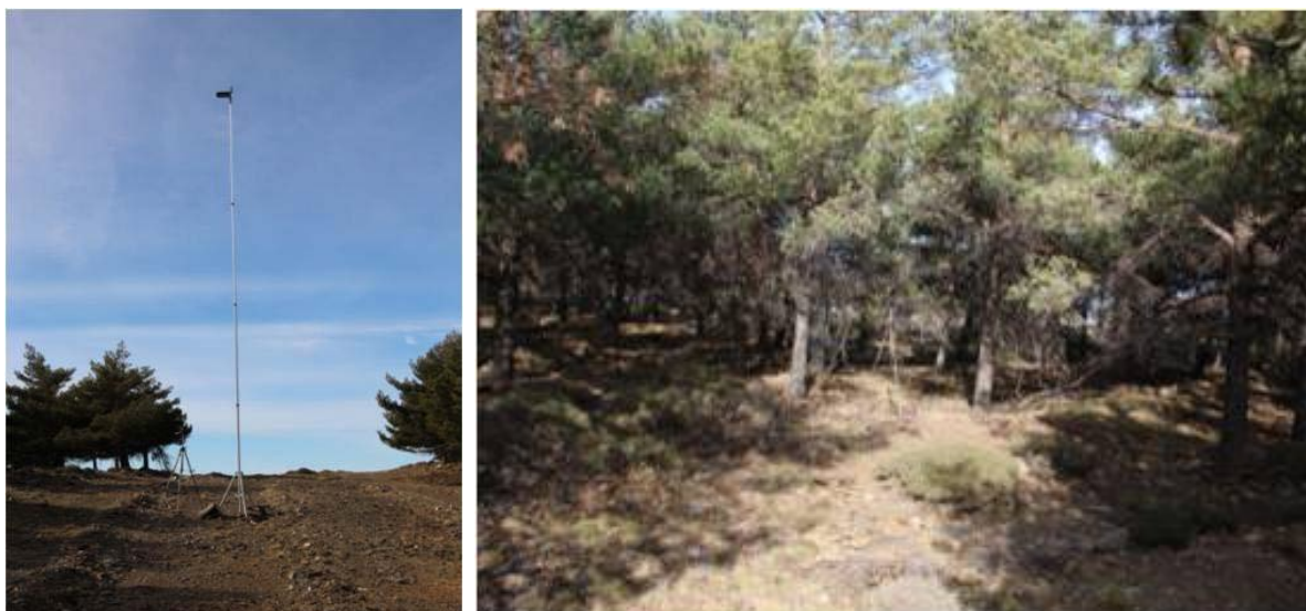
Figura 3. Estación Skywatch Geos a 6 metros de altura en una línea sin vegetación (izquierda); estación Skywatch Geos a 2 m de altura en el interior de la masa de P. sylvestris .
