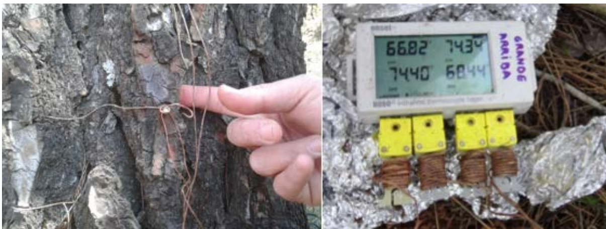
Figura 2. Termopares y su colocación en el árbol a cuatro alturas (-2, 0, 30 y 60 cm sobre el nivel del suelo) y en dos situaciones (en superficie y dentro de corteza).
