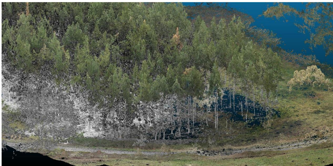
Figura 8. Unión de las nubes de puntos generadas por escaneo láser terrestre (en tono gris) y por fotogrametría RGB desde dron en la parcela de la red a gran escala de Laukiz1. Se observan algunos ápices coloreados en color rojizo, correspondientes a pinos enfermos.
