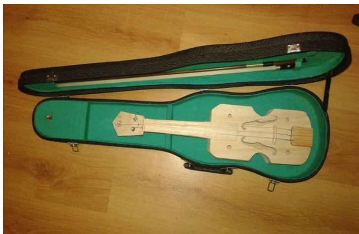
Figura 1. Rabel de Paulownia encordado preparado para la prueba de sonido
