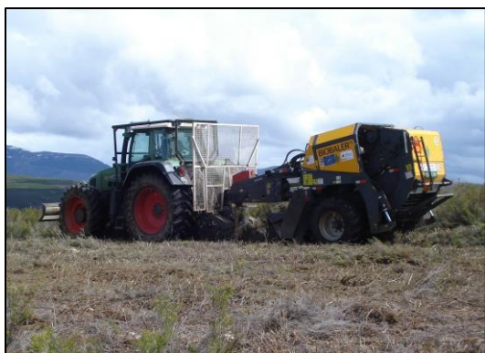
102 Figura 1. Equipo desbrozador-enfardador. A la izquierda el equipo formado por la Biobaler y un tractor agrícola. A la derecha 103 detalle de la unidad desbrozadora.
