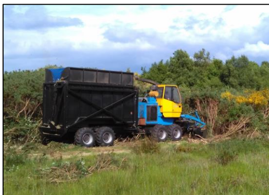
126 Figura 2. Equipo desbrozador-astillador. A la izquierda se encuentra desbrozando y a la derecha descargando la astilla en la 127 zona de acopio.
