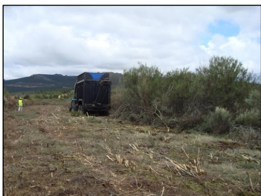
284 Figura 5. Diferencia de matorral cosechado en L6 (Figueruela de Arriba). A la izquierda Retrabío cosechando matorral de 285 más de 3 metros de altura. A la derecha Biobaler cosechando brezo de 1,5 metros de altura.
