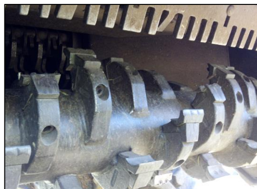
102 Figura 1. Equipo desbrozador-enfardador. A la izquierda el equipo formado por la Biobaler y un tractor agrícola. A la derecha 103 detalle de la unidad desbrozadora.
