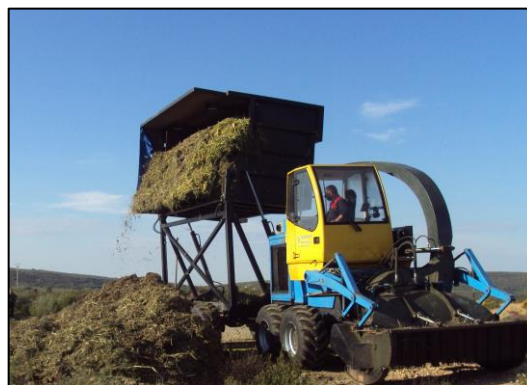
126 Figura 2. Equipo desbrozador-astillador. A la izquierda se encuentra desbrozando y a la derecha descargando la astilla en la 127 zona de acopio.
