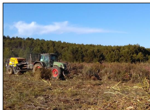
284 Figura 5. Diferencia de matorral cosechado en L6 (Figueruela de Arriba). A la izquierda Retrabío cosechando matorral de 285 más de 3 metros de altura. A la derecha Biobaler cosechando brezo de 1,5 metros de altura.
