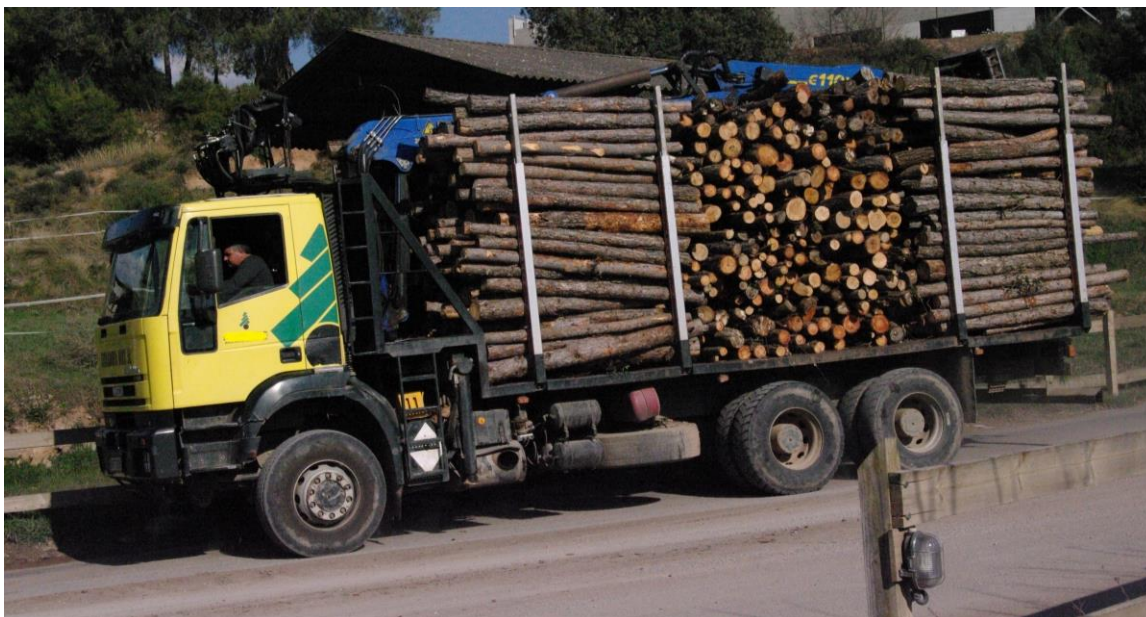
Figura 1. Camión de monte. Rígido de 3 ejes, 6x6 con grúa propia con escasa capacidad de carga. (Cataluña)
