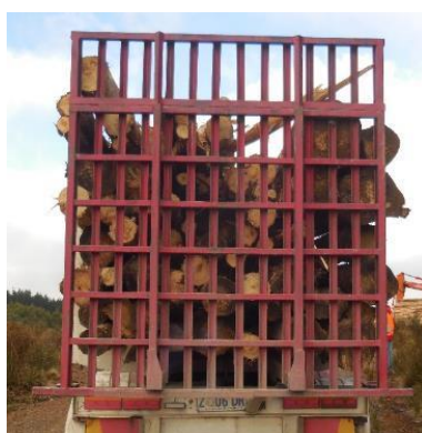
Figura 3 Pared rejilla posterior del remolque para el transporte de trozas de Eucalipto sp.
