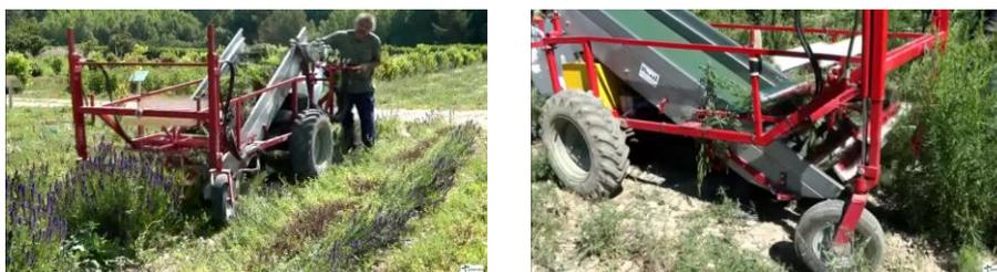
Figura 2. Máquina de corte limpio tipo tijera de la empresa JOSENEA, diseñada y construida de forma casera por la propia empresa.
