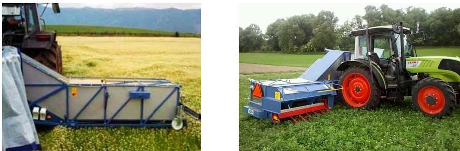
Figura 1. Modelo NB 2005 V 1.6 de EUROPRIMA. Permite tanto la recogida de flores y hojas mediante peinado, como el corte de hojas a una determinada altura
