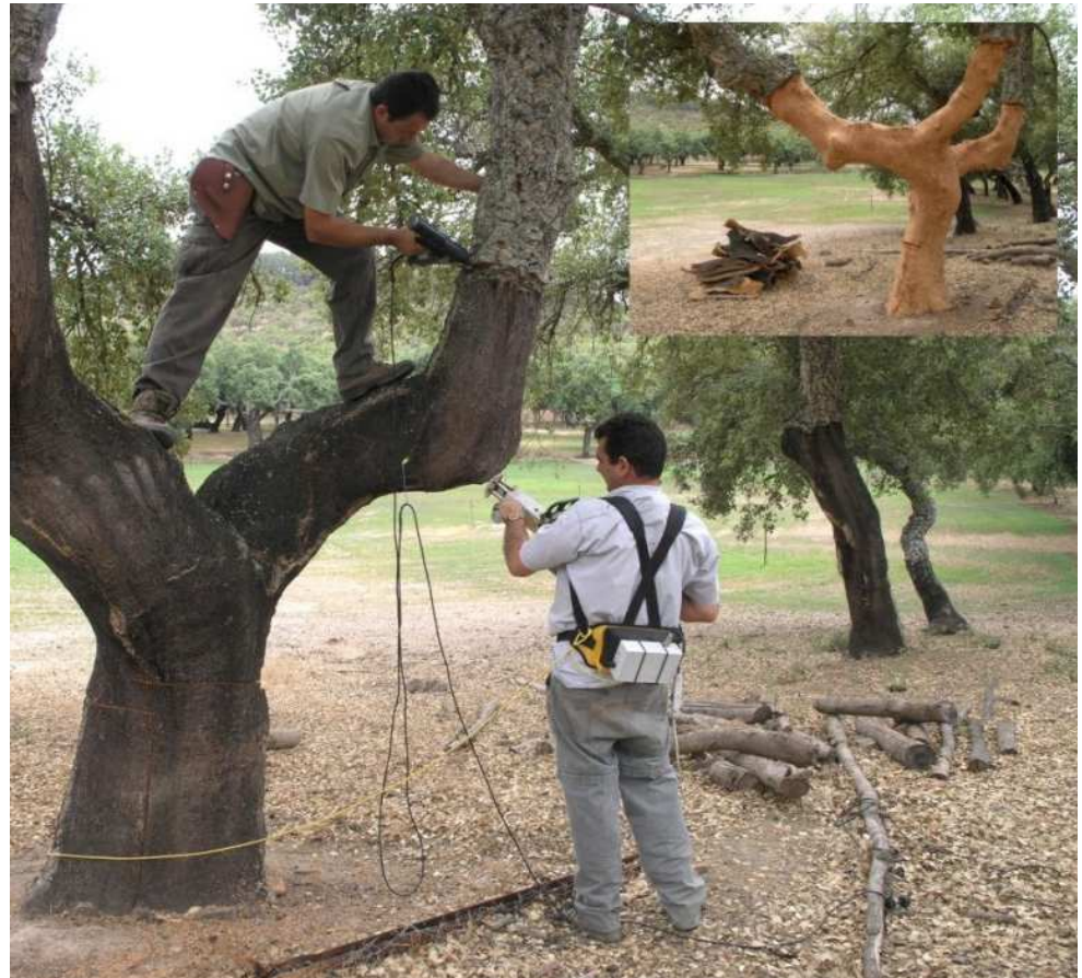
Descorche con nuevas tecnologías. Operación de abrir, el sacador de arriba con la máquina IPLA y el de abajo con la Stihl.
