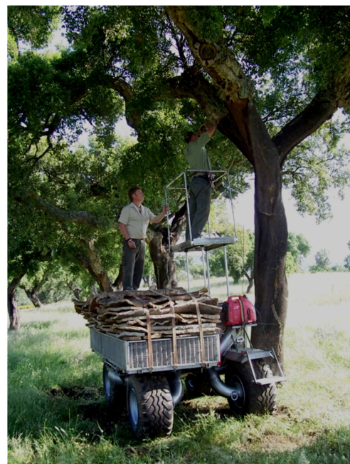
RUDO III, con la plataforma hidráulica desplegada para apoyo de trabajos de descorche.
