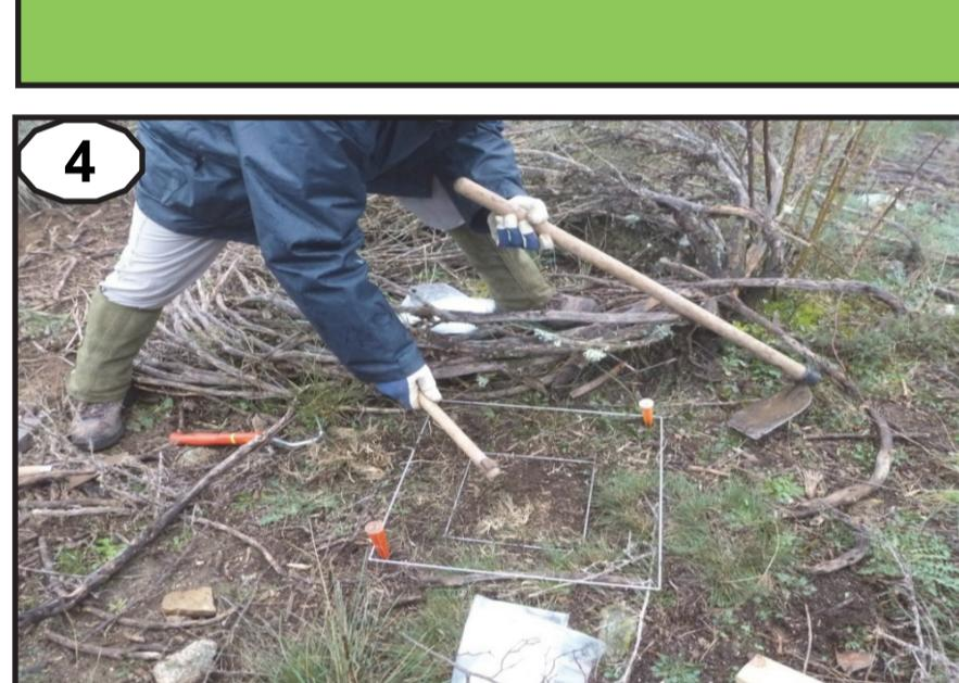
Muestreo de suelo utilizando un cilindro metálico de 5x5 cm y recogiendo tres horizontes.
