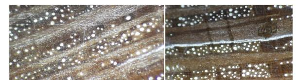
Figura 6. Ejemplo de la superficie de una rodaja de encina no acabada (izquierda), y de una superficie acabada (derecha). Fotografías tomadas en el ocular de un estereomicroscopio
