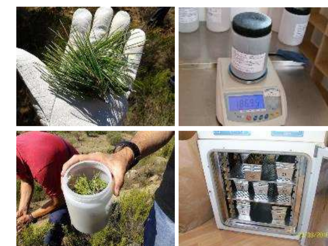
Figura 2. Toma de muestras y análisis en el laboratorio. El cálculo de la Humedad del Combustible Vivo se realiza según la fórmula siguiente, tras secado a 100°C durante 24h, siendo el PesoVerde = PesoTotal - PesoBote .
