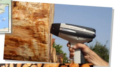
El espectrómetro portátil NIR empleado ha sido el *Microphazir* (Thermofisher). En cada individuo se han tomado 5 medidas tanto en el corte transversal como tangencial y sin tratamiento previo. Los espectros obtenidos (1.150) han sido tratados estadísticamente mediante el software comercial *Unscrambler 10.4*.
