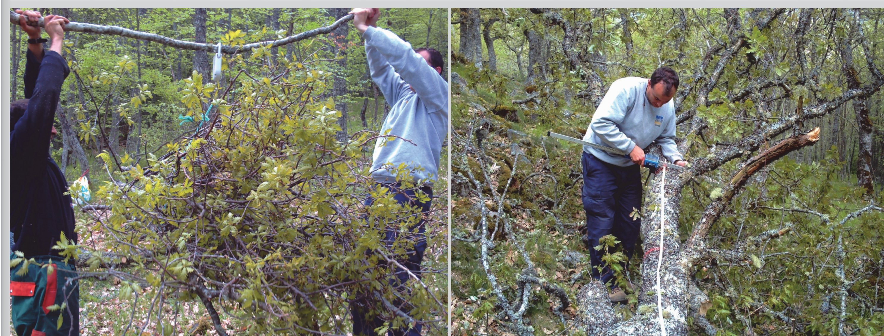
Figura 2: pesado de las fracciones de biomasa (izquierda), medición de los diámetros a lo largo del tronco (derecha).
