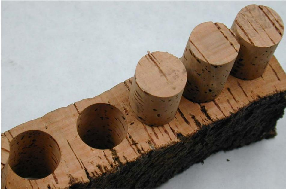
La producción de tapones necesita de una capa de corcho de espesor homogéneo y superior a el diametro del tapón
