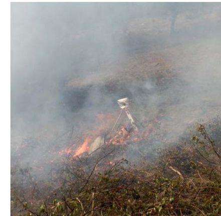
Evaluación del calor convectivo, mediante el uso de radiómetros
