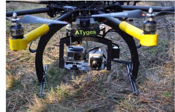
Imágenes captadas por sensores transportados por un UAV (cámara RGB, multispectral y térmica)
