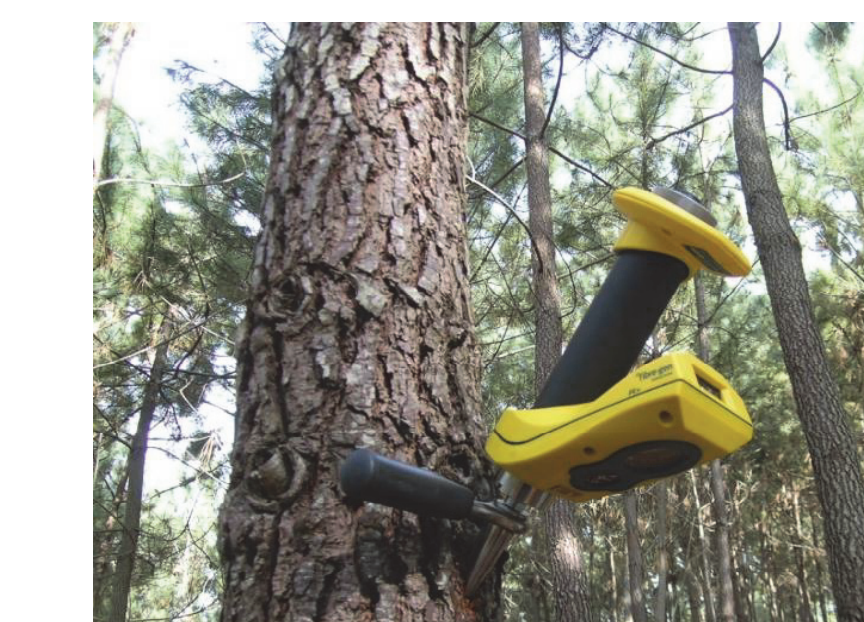
Velocidad acústica (NDT) en árboles en pie de P. pinaster
