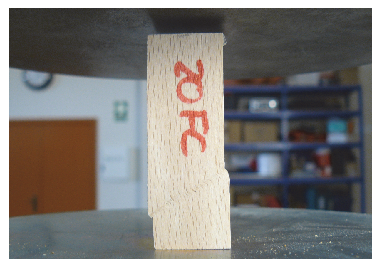
Figura 1 y 2. Ensayo a compresión axial y flexión estática
